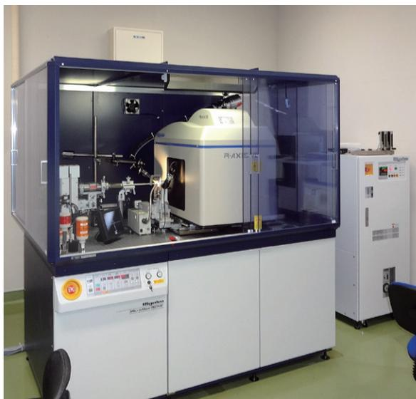
タンパク質結晶X線立体構造解析システム
