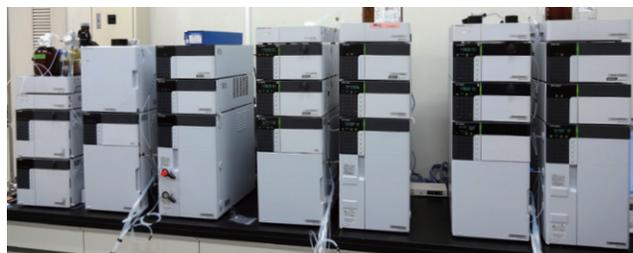
HPLC(高速液体クロマトグラフ分析システム)
