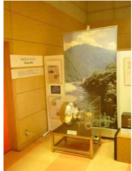
【中央】光電子増倍管（実物） 【右】液体シンチレータ（実物、ハンズオン） 荷電粒子を当てると、水は感じないが液シンは光る。感度が良く低エネルギーが計れることが分る。 【奥右】実験場ロケーションのパナー 【奥左】新聞記事
