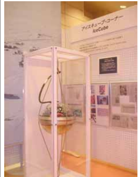
【中央】光電子増倍管（実物）、氷河に穴をあけてつり下げたため、ガラスの保護球入。 【左】南極風景パナー（実験場ロケーション） 【右】新聞記事
