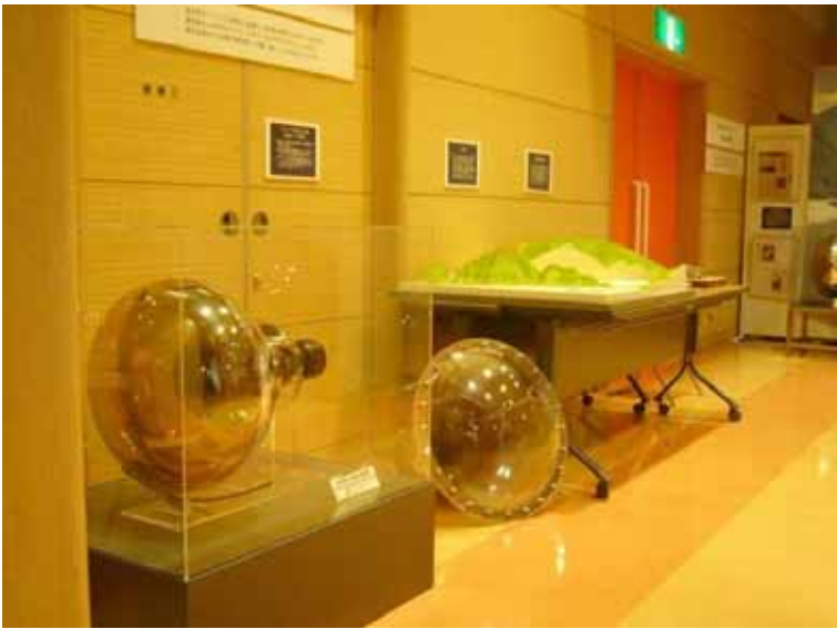
【手前】光電子増倍管（実物） 【中央】防爆ケース（実物、さわれる）光電子増倍管のケース 光電子増倍管の爆縮を防ぐと共に、もし爆縮が起こっても、流れ込む水流の勢いをコントロールして弱め、衝撃波を防いで、隣の光電子増倍管を割らなくて済む様に設計されている。 【奥】「池の山」精密等高立体地図
