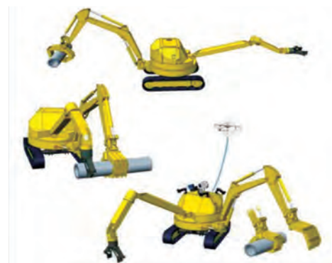
図 3-4-16 二重回旋型の双腕建設ロボット 9)
