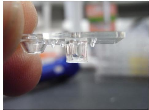
図4 固相中結晶化ツール GEM プレート
