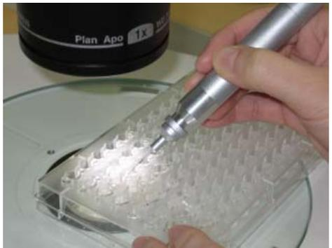
図5 結晶取りだしツール クリスタルキャッチャー
