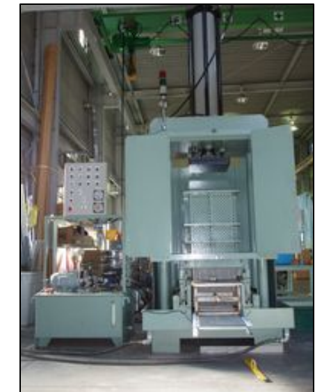
図2. 板状圧縮成型用の大型成型機
