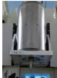
新規超音波援用スピンドル 【(株)岳将】 スピンドル取付部外径φ125mm 最高回転速度：20,000rpm 振れまわり：0.5μm
