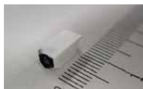
DC電界印加によって生じる強還元(黒色化部分)組織 (Heat Core) 部分安定化ジルコニアセラミックス (3mol%Y 2 O 3 -ZrO 2 (3YSZ) の例)
