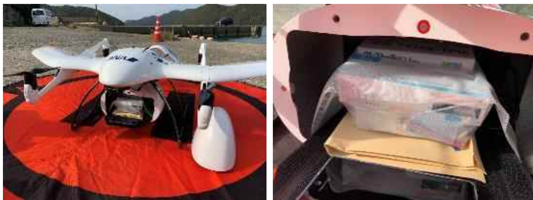
図10：ドローン下部の格納室に医薬品が収納されている。
