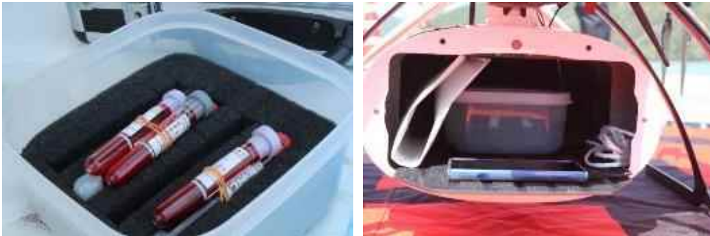
図13：血液検体2名分をクッションで覆った上で容器に納め、ドローンに格納した。
